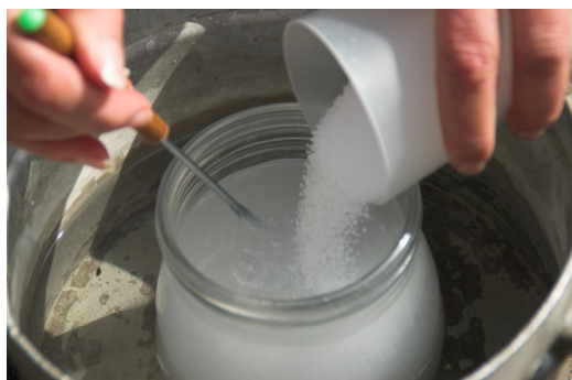
1 : Dilution de la soude dans l'eau
