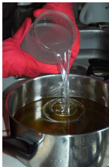
4 : Ajout de la soude dans les huiles à 40°C
